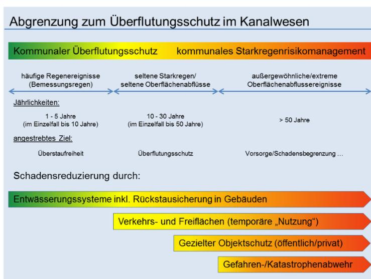
Abbildung 4: Abgrenzung zum Überflutungsschutz im Kanalwesen (LUBW, 2016 – angepasst nach Scheibel, 2017).
