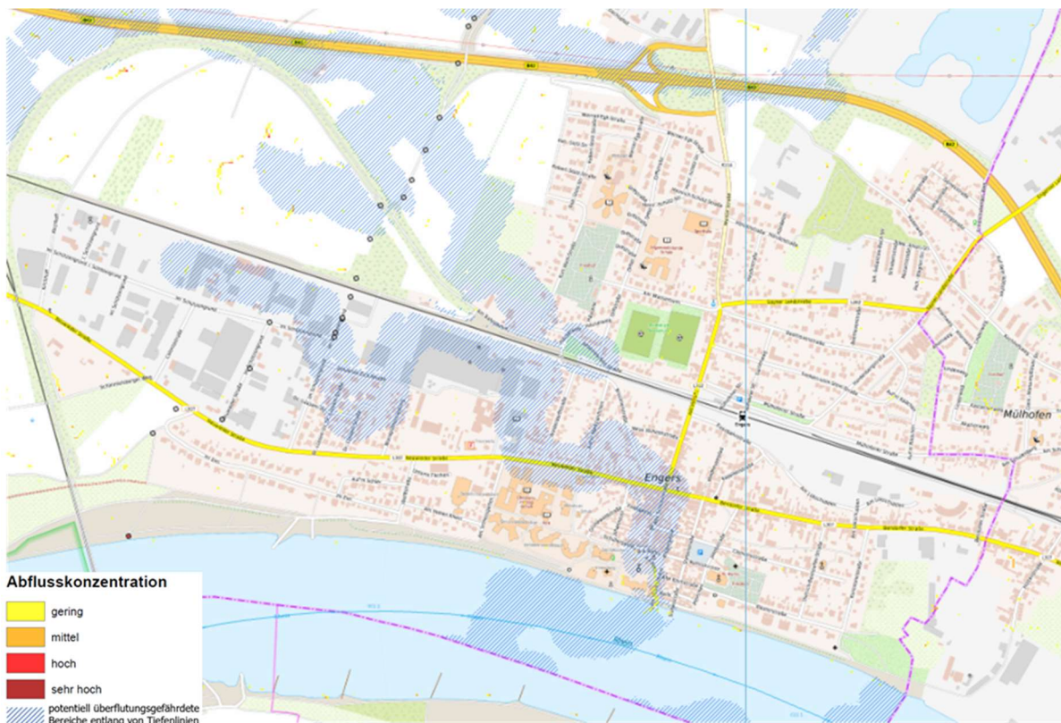
Abbildung 5.3: Ausschnitt von Engers mit Informationen aus der Starkregenhinweiskarte des Landes RLP ([2], [3]).
