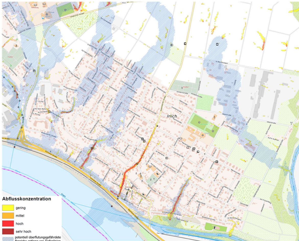
Abbildung 5.8: Ausschnitt von Irlich mit Informationen aus der Starkregenhinweiskarte des Landes RLP ([2], [3]).
