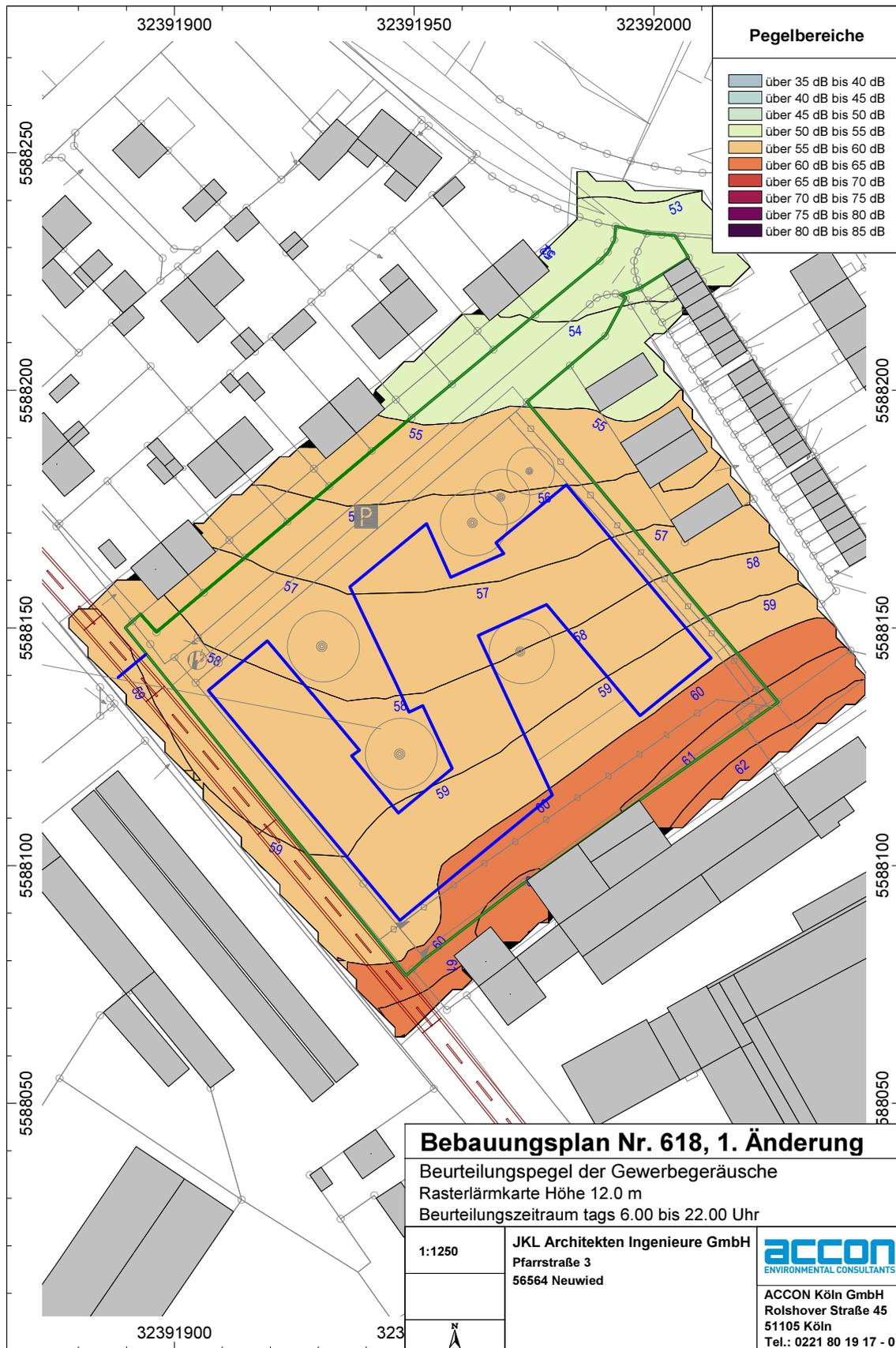
**Abb. 2** Gewerbelärmimmissionen unter Berücksichtigung der Flächenpegel gemäß Abb. 1 für eine freie Schallausbreitung innerhalb des Plangebietes für eine Höhe von 12 m über Grund, tags
