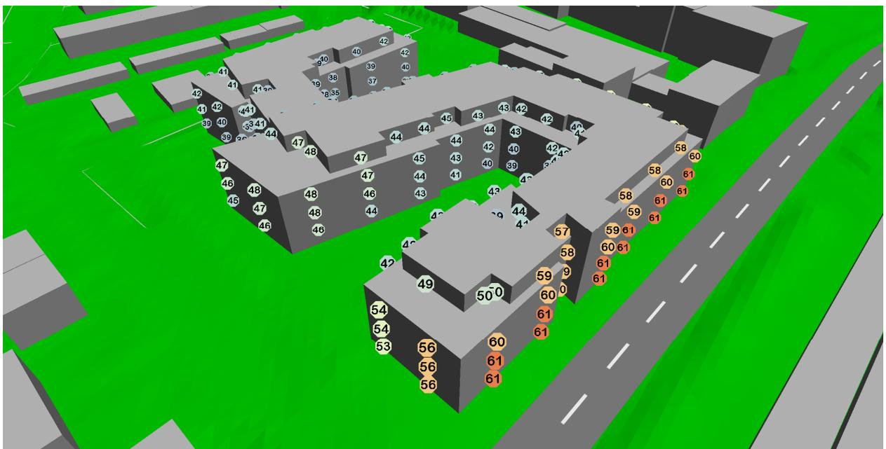
**Abb. 8** Verkehrsgeräuschpegel an den Fassaden, Ansicht von Nordwesten, Nachtwerte
