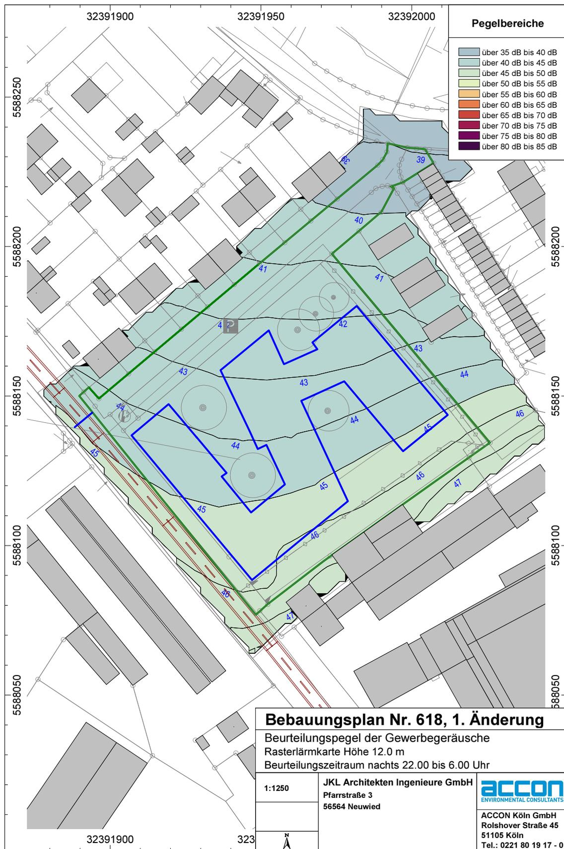
**Abb. 3** Gewerbelärmimmissionen unter Berücksichtigung der Flächenpegel gemäß Abb. 1 für eine freie Schallausbreitung innerhalb des Plangebietes für eine Höhe von 12 m über Grund, nachts
